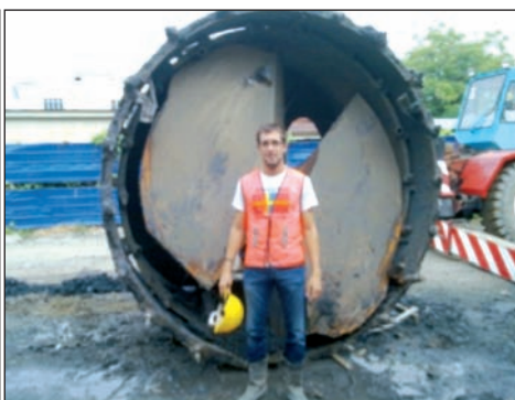
[Figura 3] .- Herramienta de Ø 2800 mm (Altura del técnico 1,77 m).
