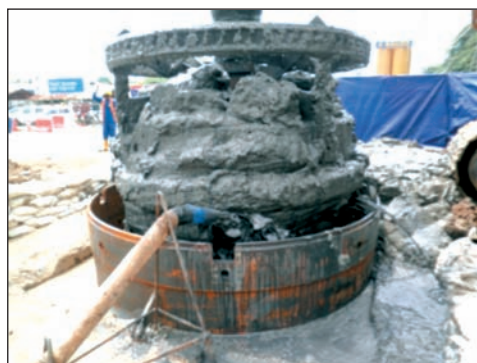
[Figura 3] .- Herramienta de Ø 2800 mm (Altura del técnico 1,77 m).
